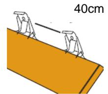
Le dessin ci-dessous indique les endroits où les clips doivent être fixés à la plinthe.
