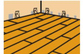
Attention ! L'utilisation des clips Pergo® a des conséquences sur la découpe en biais. En effet, à cause des clips, la plinthe est un peu inclinée. Utilisez l'accessoire fourni pour scier vos plinthes selon un biais parfait (voir dessin).
