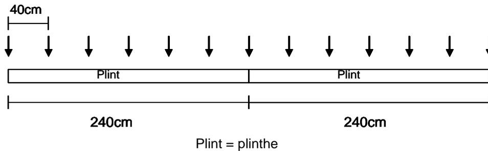
Remarque : pour des murs inégaux, il est recommandé d'utiliser davantage de clips. Si les irrégularités sont trop importantes, des ouvertures entre le mur et la plinthe sont inévitables.
